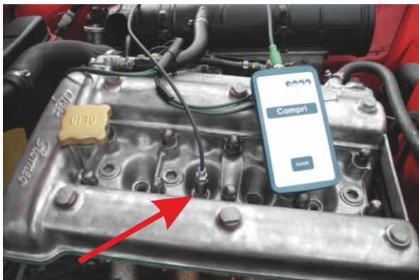
Eingebauter Compri Zylinderdrucksensor an einem Zylinder des Alfa GT1300 Motors
