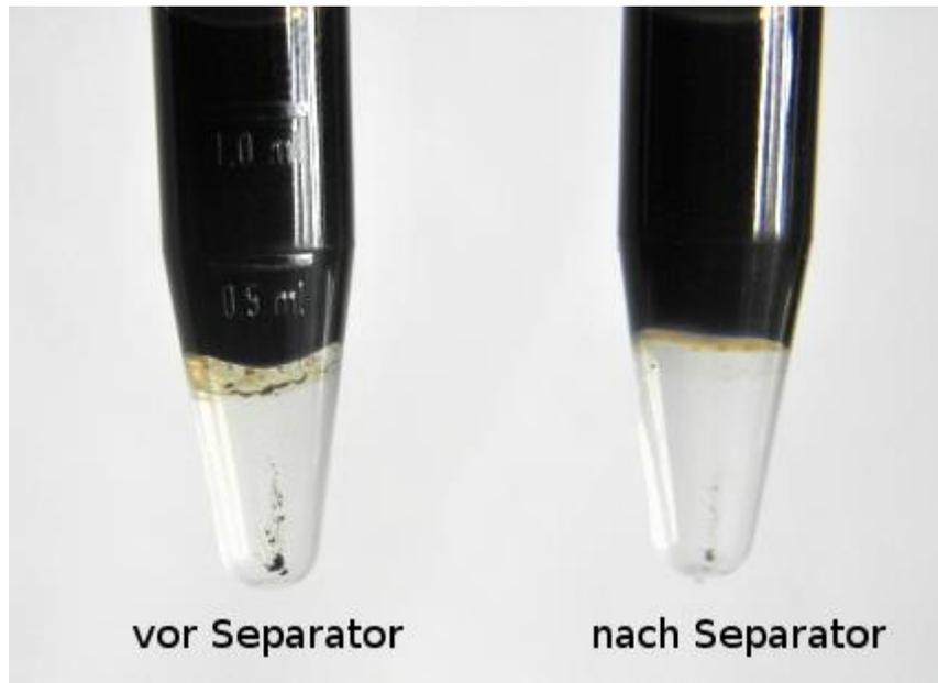
Ein bedeutendes Merkmal der Qualität von Schweröl ist der Anteil der Cat Fines. Durch den Reinigungsprozess in einem Separator, soll das Niveau der Cat Fines maßgeblich reduziert werden. Damit hilft der MT CAT FINES CHECK einerseits die Qualität des gelieferten Schweröls zu bewerten, und andererseits die Funktionsfähigkeit der Reinigungssysteme und der Separatoren sicherzustellen.
